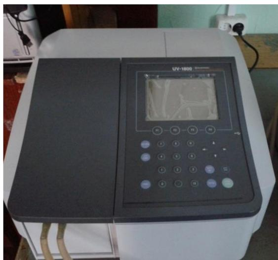
**Двухлучевой спектрофотометр Shimadzu UV-1800**
