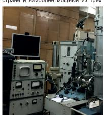
Он позволяет проводить синхронные электронографические и массспектрометрические эксперименты, оперативно реагировать на отклонения от оптимальных условий эксперимента и принципиально подостовервышает ность структурных данных.
