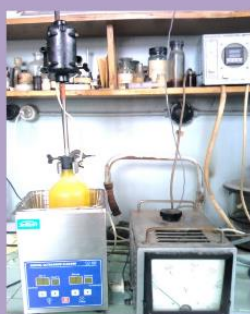
Опыт №4 Ультразвуковая ванна + механическое перемешивание
