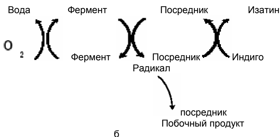
Рис. 46. Схема каталитического окисления индиго(а), схема действия лакказы в процессе деколорирования окрашенной хлопчатобумажной ткани Ъу.
