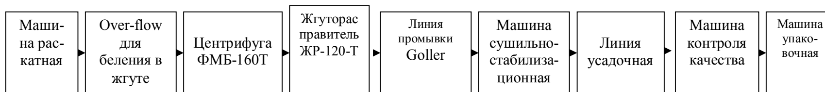
Рис.26. Условная структурная схема технологического оборудования для беления хлопчатобумажного трикотажного полотна
