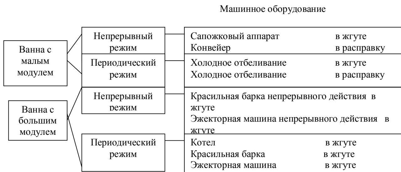
Рис. 4. Типы машинного оборудования для подготовки трикотажного полотна
