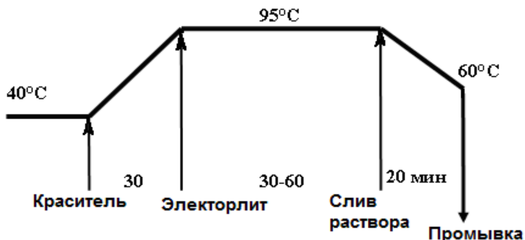
Рис. 17. Пример технологии крашения прямым красителем Сатурн (стандартный метод крашения)
