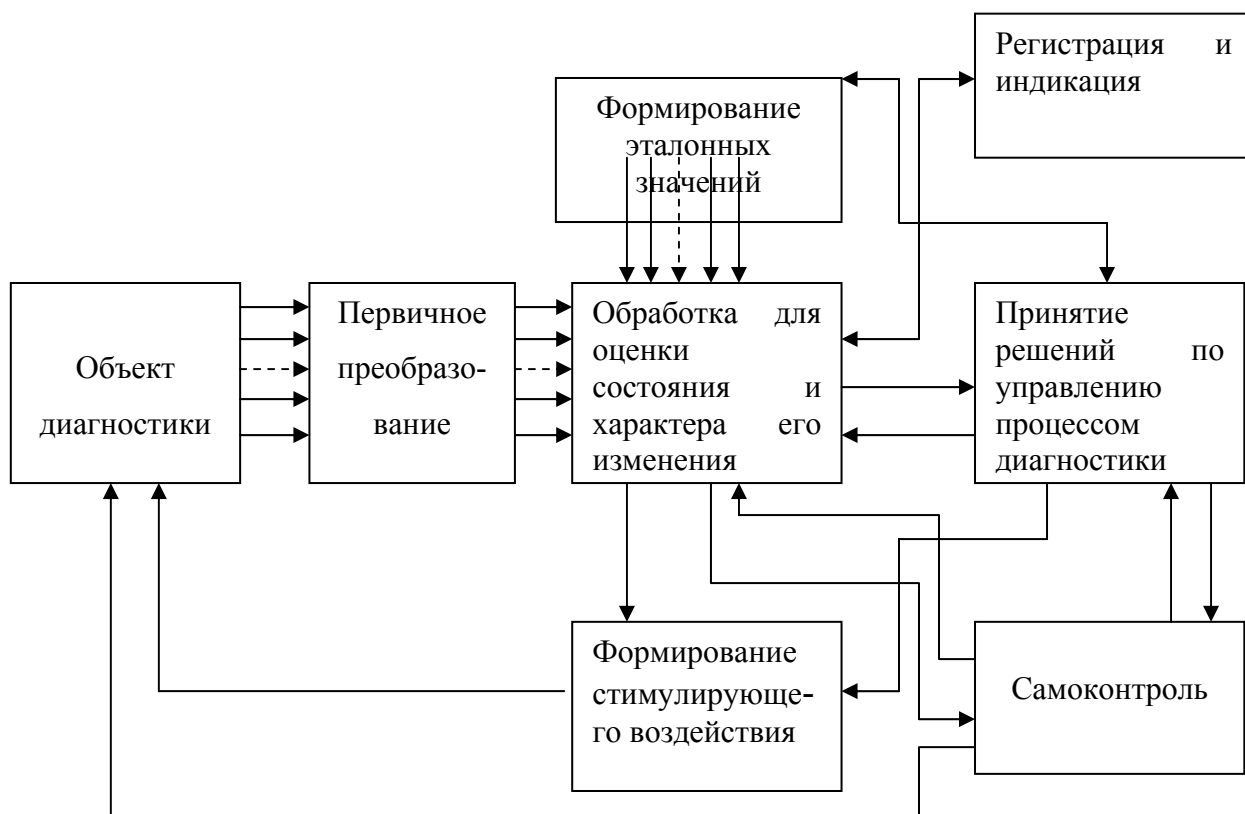
Рис.21 Структурная схема диагностики технических объектов
