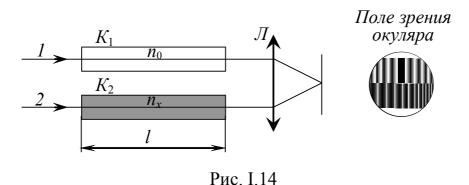
Когерентные световые лучи 1 и 2 проходят через две одинаковые кюветы  $K_1$  и  $K_2$  длиной l. Одна из кювет заполнена веществом с известным показателем преломления  $n_0$ , а другая кювета заполнена веществом, показатель преломления которого  $n_{\rm x}$  нужно определить. Между интерферирующими лучами возникает оптическая разность хода
