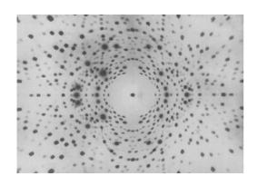
граммой, представляет собой совокупность концентрических дифракционных колец. Анализ лауэграммы или дебаеграммы позволяет получить сведения о структуре кристаллов.
