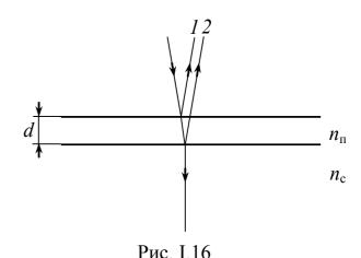
ческая разность хода световых волн 1 и 2, отраженных от верхней и от нижней поверхности пленки, равна  $2dn_{\pi}$ . Для того чтобы отраженные волны 1 и 2 ослабляли друг друга, минимальная разность хода в соответствии с условием интер-
