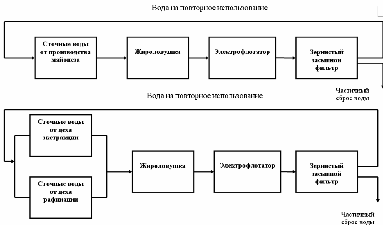
Рис. 3. Функциональная блок-схема ВХТС локальной обработки сточных вод масложирового производства.
