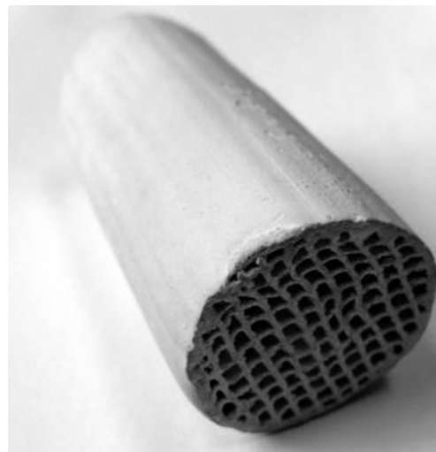
Рис. 11. Носитель катализатора паровой конверсии природного газа из титаната алюминия
