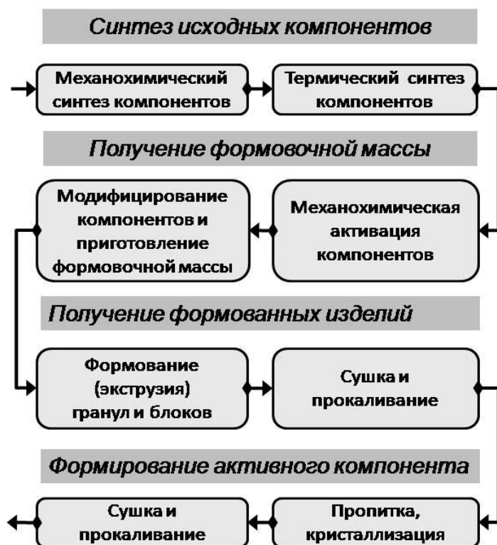
Рис. 12. Принципиальная блок-схема получения экструдированных катализаторов и сорбентов по механохимической технологии
