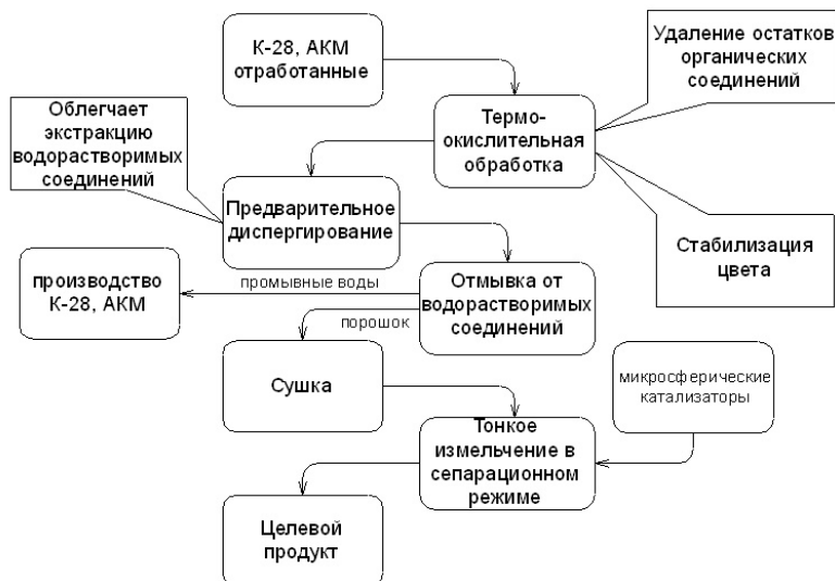
Рисунок 9. Технологическая схема получения пигментов и наполнителей из отработанных катализаторов
