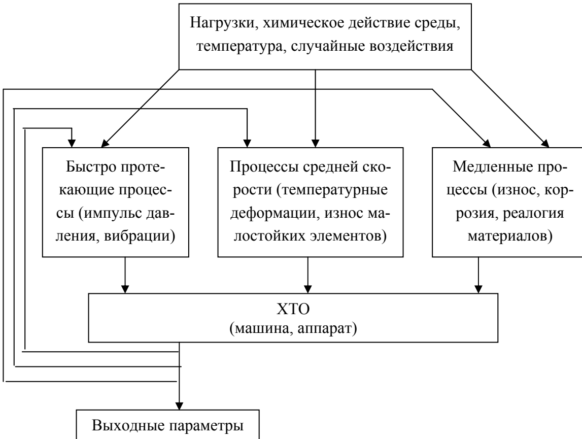
Рис. 4. Структура внешних воздействий на конструкцию
