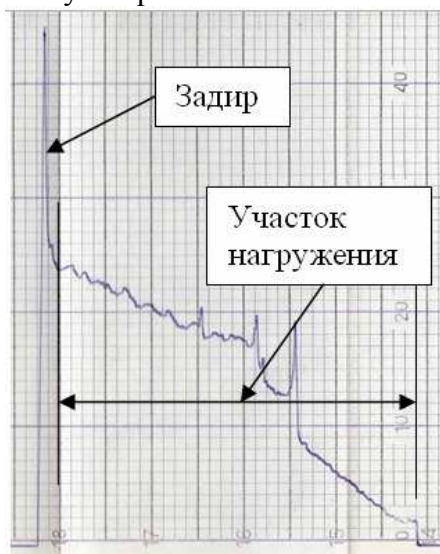
Рис.1. Пример трибограммы нагружения и задира стальной пары трения
